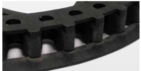
Tekenen van slijtage aan een CDS eco tandwiel
