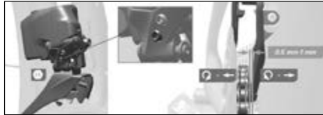
Afb. 97 Bovenste aanslag instellen ©Sram
